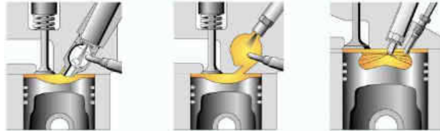
Tre tipologie di motore diesel: il primo da sinistra è un sistema a precamera, il secondo un sistema a camera di turbolenza e il terzo è un sistema ad iniezione diretta.
